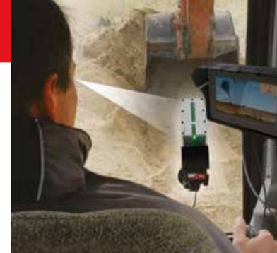
Die transparente LED-Anzeige ermöglicht gleichzeitige Sicht auf den Löffel und die aktuelle Grabtiefe
